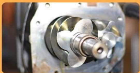
Rénovation de bloc vis
