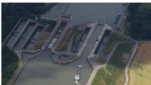
Site d'Uelzen (Allemagne) présentant une écluse à bassins d'épargnes séparés (à gauche) et une écluse à bassins intégrés dans ses bajoyers (à droite)
