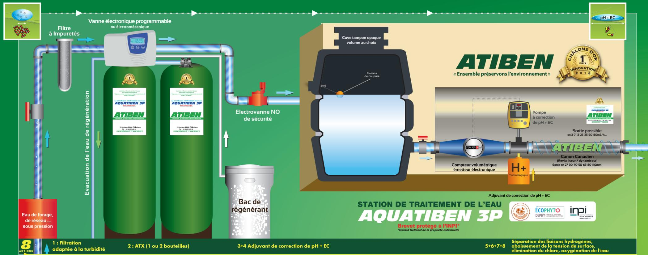
Solution avec cuve tampon permettant un remplissage lent de la cuve (solution économique) et une sortie de cuve à haut débit afin de ne pas perdre de temps.
