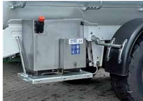
Installation de dosage pour inhibiteurs de nitrification
