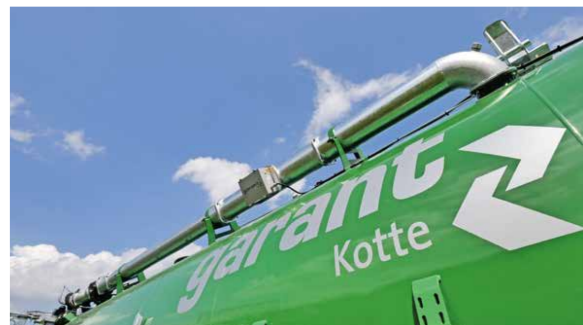
Capteur NIR sur une citerne avec pompe volumétrique ou centrifuge
