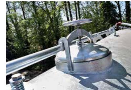
Dôme de remplissage mécanique avec trappe pivotante pour tonne à lisier sous vide
