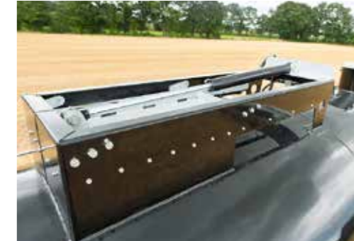
Dôme de remplissage hydraulique avec trappe coulissante pour camion-citerne à pompe
