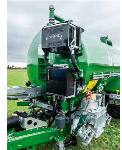
Tonne à lisier avec pompe à lobes avec système hydraulique embarqué
