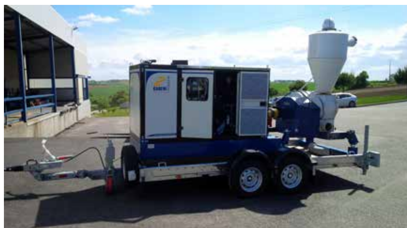
Grain transfer suction blower Aspirateur et souffleur par vide pour transfert de céréales
