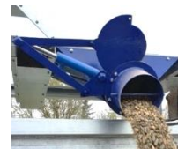
Ouverture hydraulique par vérin double effet
