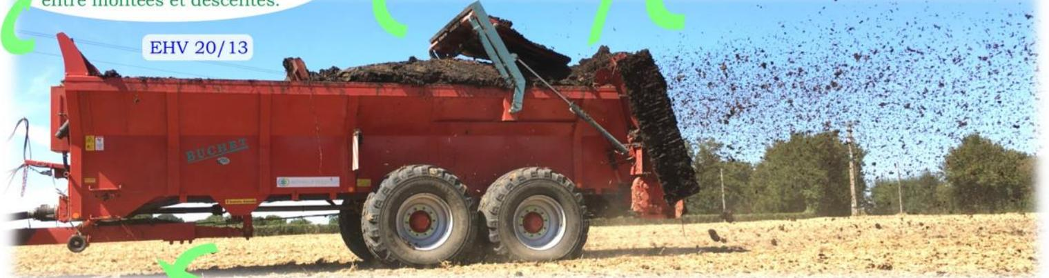
5. Plancher bas, caisse large en haut (2,20 m). L'épandeur est stable et rapide à charger.
