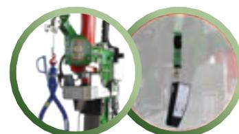
Treuil avec commande manuel ou radiocommande
