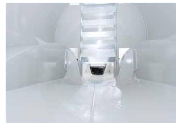
Brise-lames vissés, passages de roues renforcés et revêtement intérieur en résine époxyde à 2 composants
