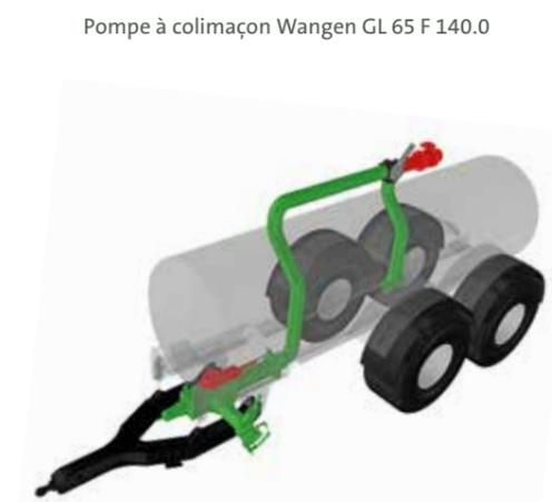
Mode de fonctionnement « remplissage » avec Excenter TopFlow
