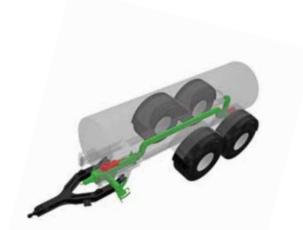
Mode de fonctionnement « remplissage » avec excentrique Eco-Variante
