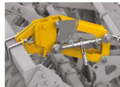
Système de démontage rapide de la barre de semis.
