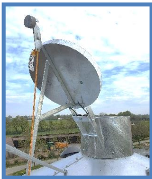
Réhausse de couvercle avec masselotte de verrouillage
