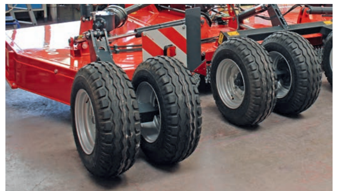
Plusieurs options pneumatiques possibles, pour des travaux efficaces dans toutes les situations : BKT AW702 (10PR) ou MP567 (18PR)
