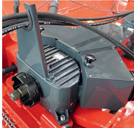
Boîtier diviseur - puissance admissible de 290 ch - contenance d'huile: 3,8 litres
