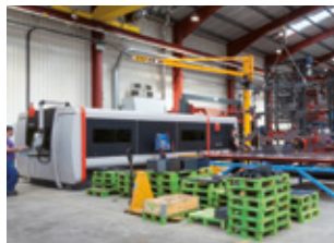
2 lasers de découpe tôle par fibre
