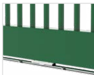
3- Poutre basse / Rail / Roue
