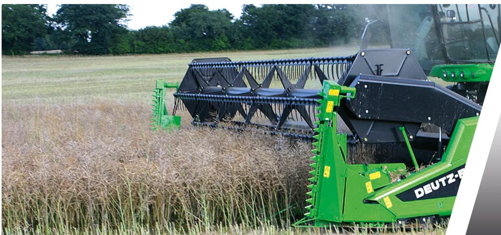
> Un kit spécialement conçu pour le colza a été mis au point, qui s'applique à toutes les barres de coupe DEUTZ-FAHR standard jusqu'à 7,2 m.
