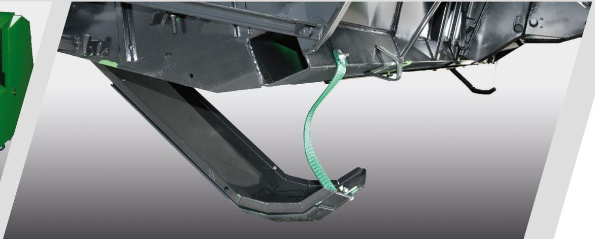
> De robustes plaques de protection intègrent les capteurs au sol pour contrôler la position de la barre de coupe, même sur terrains irréguliers.
