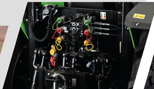
> Jusqu'à 3 distributeurs arrière avec régulateur de débit.
