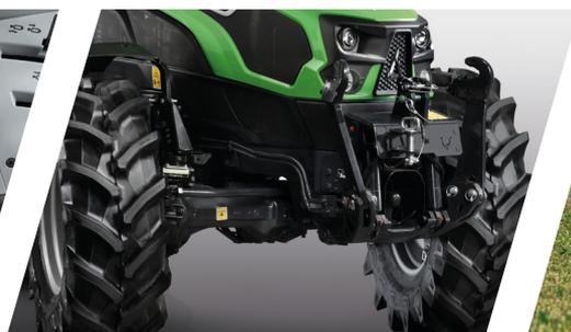
> Sur demande, les modèles 5D peuvent être équipés de relevage avant et de PDF avant.
