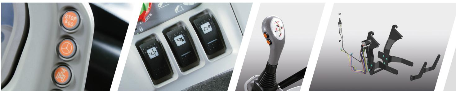
> En fonction du modèle de tracteur, joystick du chargeur frontal avec boutons Powershift. La fonction Stop&Go, le système de braquage rapide SDD et toutes les commandes pour le fonctionnement du chargeur frontal sont entièrement intégrées et à portée de main.
