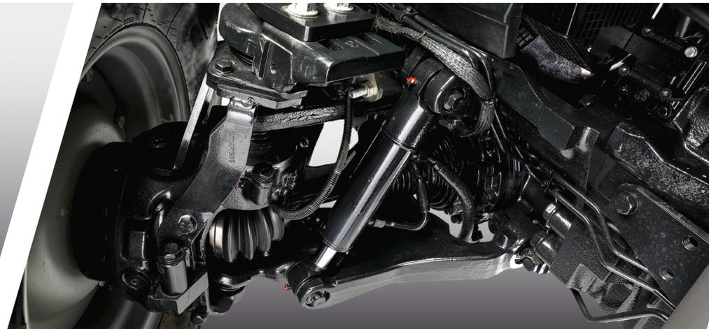
> Suspension de pont avant à roues indépendantes.
