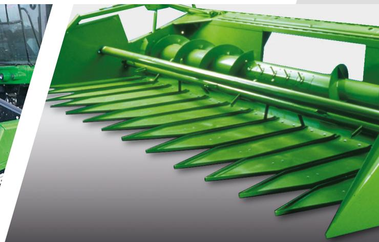
> Pour la moisson du tournesol, un kit a été conçu et peut être monté sur toutes les barres de coupe DEUTZ-FAHR jusqu'à 7,20 m de large.
