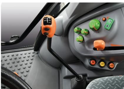
> Relevage arrière électronique avec système d'amortissement des vibrations.
