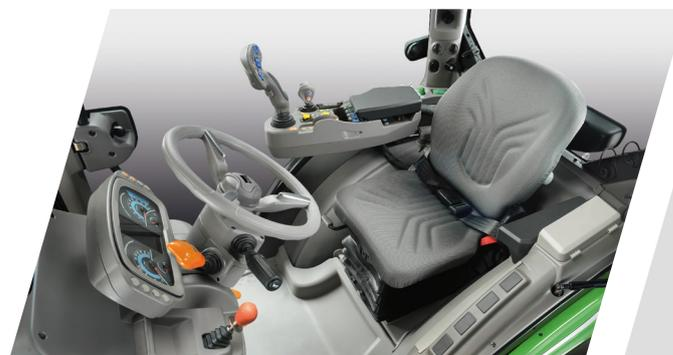
> Cabine spacieuse à 4 montants avec plancher entièrement plat grâce à la transmission TTV compacte basse.
