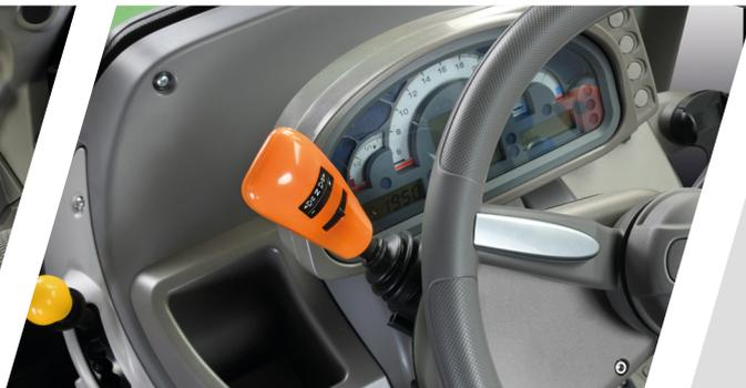
> Inverseur hydraulique avec SenseClutch.
