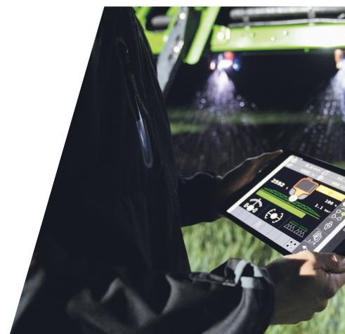
> Fonction XTEND avec tablette, contrôle des outils via ISOBUS UT tout en étant hors de la cabine.
