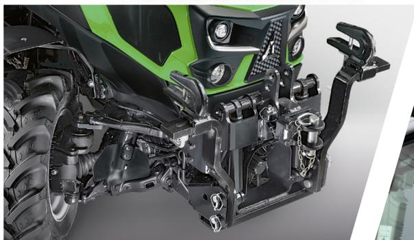
> Suspension de pont avant à roues indépendantes.
