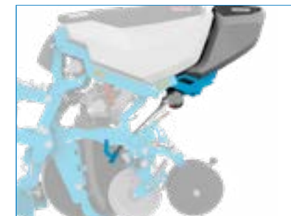
MicroSmart insecticide /engrais AR (V3) Trémie 20L (par rang)
