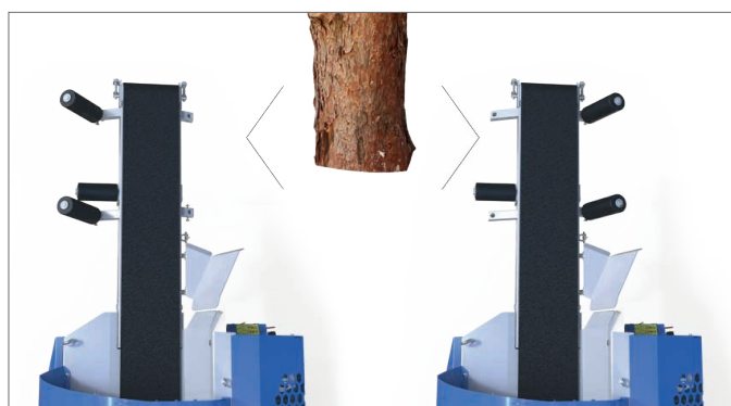
Chargement possible du bois à droite ou à gauche.
