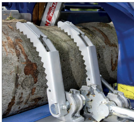
Le système de maintien de bois empêche la rotation du tronc et garantit un transfert optimal vers le canal de fente.
