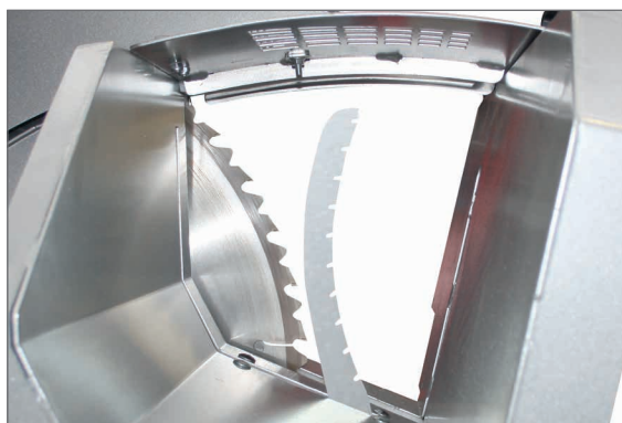
Bras de maintien automatique de bûches pendant le sciage
