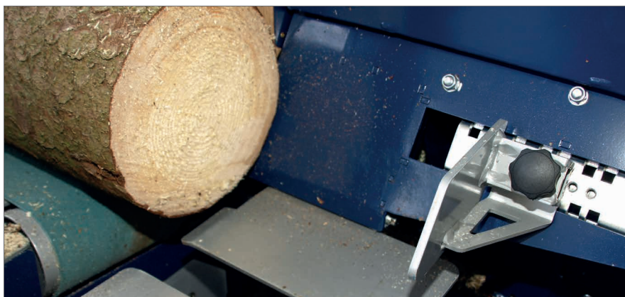
2 trappes restent en position horizontale pendant le sciage. Elles s'ouvrent après la coupe pour un positionnement optimal du bois dans le canal de fente.
