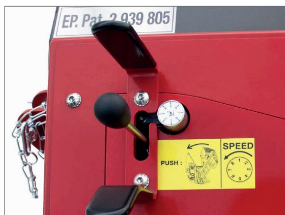
Commandes du chevalet hydraulique et réglage de la vitesse
