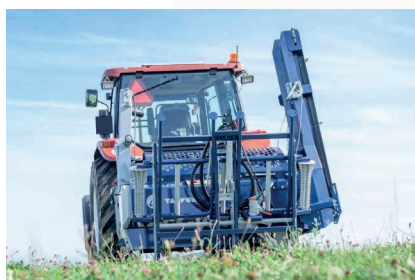
Combiné RCA en position de transport
