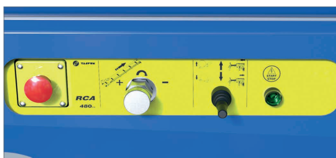
À gauche se trouve le bouton d'arrêt d'urgence. Le bouton central permet de régler la vitesse du tapis roulant et l'interrupteur de droite permet de commander les accessoires.
