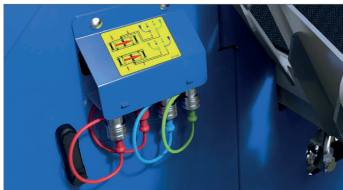
Sortie hydraulique pour deck ou autres accessoires.
