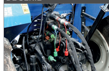
Branchement hydraulique directement sur le tracteur
