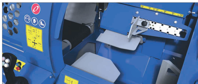
La butée hydraulique de longueur de coupe réglable de 25 à 50 cm. La butée se déplace de 5 cm pour libérer le bois scié dans sa chute. Deux clapets de déversement s'ouvrent automatiquement et as- surent une chute correcte du bois.
