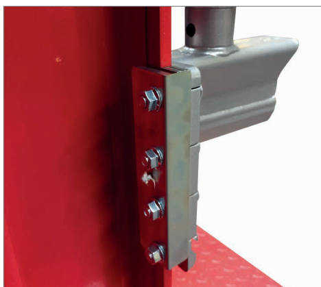
Glissières en laiton avec graisseurs
