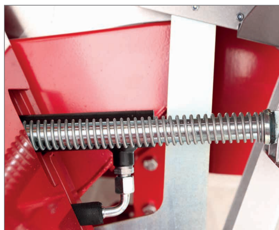
Chevalet à basculement hydraulique
