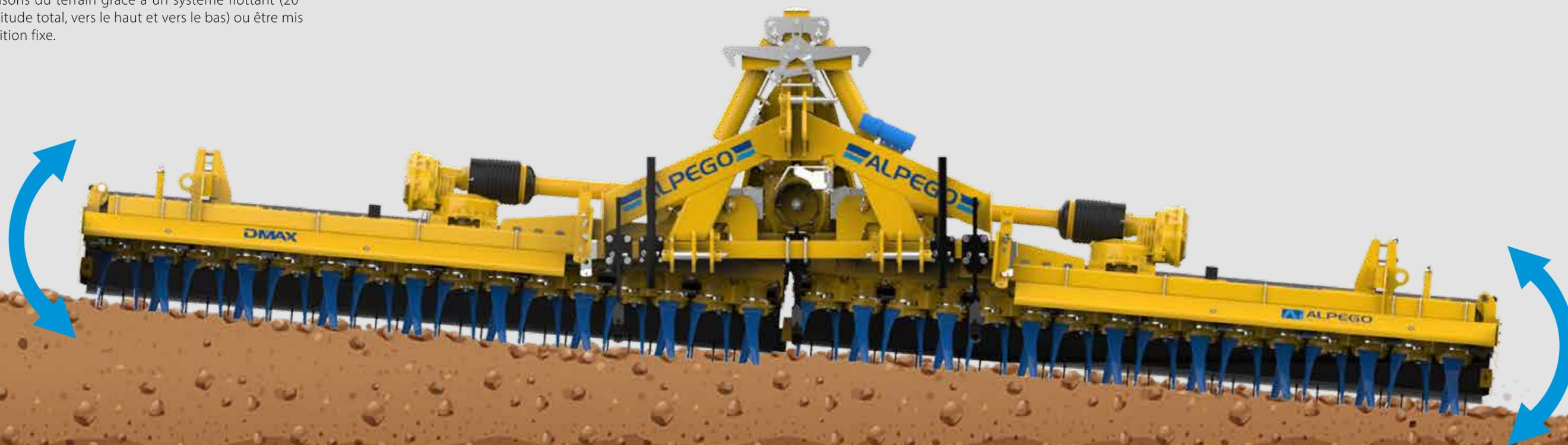
La herse rotative repliable DJ est dotée d'une structure en acier à haute résistance, ce qui lui permet d'offrir des performances structurelles élevées tout en ayant un faible poids.
