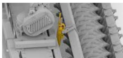
RÉGLAGE HYDRAULIQUE DE LA BARRE NIVELEUSE
