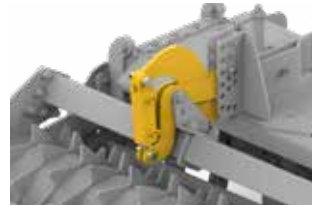
CONTRÔLE HYDRAULIQUE DE PROFONDEUR
