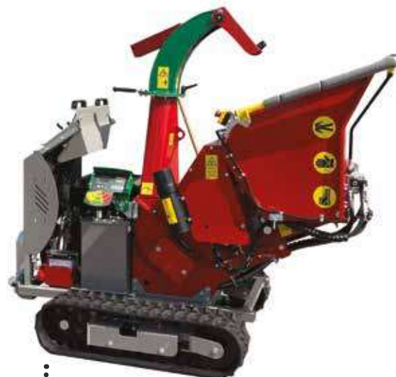
... CHENILLES HYDROSTATIQUES (GRANDE CAPACITÉ DE FRANCHISSEMENT)
