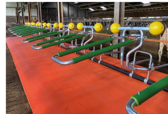
Les séparateurs conventionnels ont été remplacés par des cadres de guidage horizontaux pour un bon positionnement de la vache dans la stalle. De cette façon, la base de la stalle peut être considérablement élargie sans en compromettre la propreté. Les vaches peuvent se reposer dans toutes les positions corporelles naturelles sans être limitées dans leurs mouvements par des barres ou des vaches voisines.
