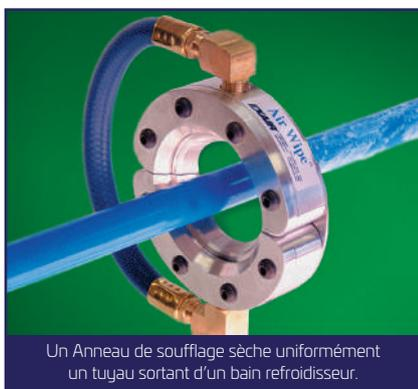
Un Anneau de soufflage sèche uniformément un tuyau sortant d'un bain refroidisseur.
