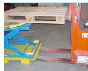
Réhausse pour chargement au moyen d'un gerbeur
