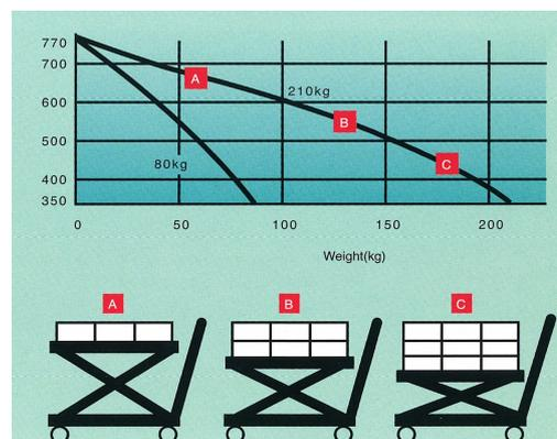
Tableau de charges et de hauteurs (type ESX21) avec un réglage à 210 kg et 80 kg.
