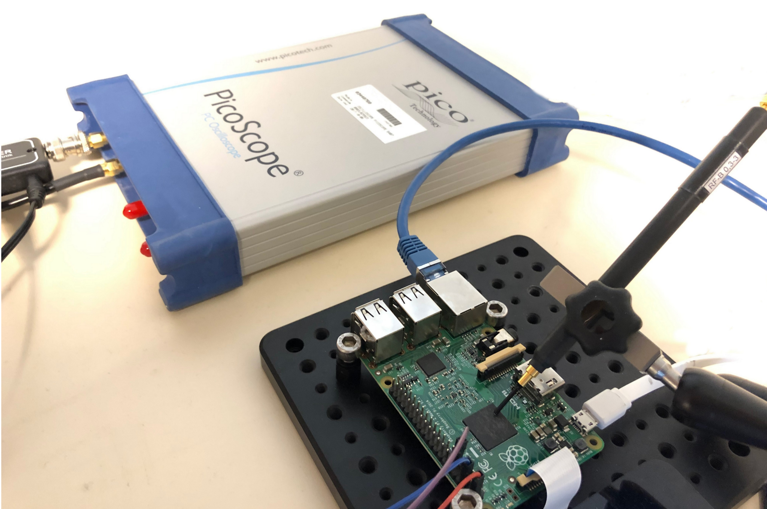
Fig. 1 : Équipement d'acquisition de fuite électromagnétique.
