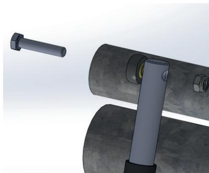
7- L'écrou doit être bloqué.
