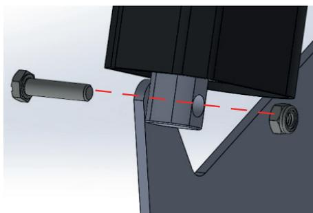
5- L'écrou ne doit pas être bloqué, le vérin doit pouvoir pivoter autour de l'axe de la vis.
