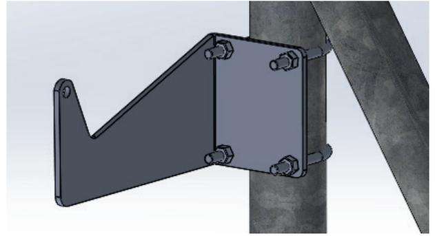
2- La rotule d'accouplement peut être fixée à la place de la poignée d'accouplement sinon percez la tringle de manœuvre.
