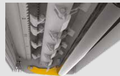
ROULEAU PALPEUR ARRIÈRE Rouleau arrière monté sur des roulements protégés
