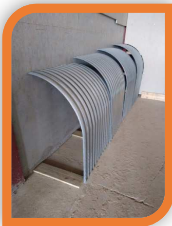
Demi-gaines de ventilation
