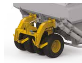
TASSE AVANT INTÉGRÉ (PNEUS 10.0/75 - 15.3 - DIAM. 740MM)
