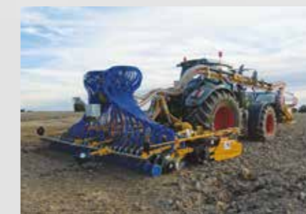
AS-MAX Bitube avec herse rotative Alpego
