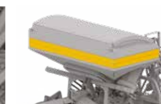
REHAUSSE DE TRÉMIE 250 LITRES
