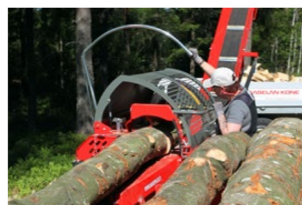
L'hydraulique à entraînement direct de la machine active les fonctions simultanées avec des mouvements sans effort du levier de commande.
