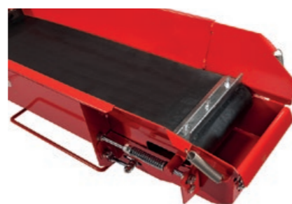
Convoyeur de sortie nettoyant breveté de série. La rainure à l'extrémité du convoyeur de sortie sépare les débris du bois à brûler.
