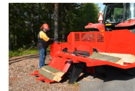
L'élévateur de grumes hydraulique permet la manipulation de gros troncs sans effort supplémentaire.
