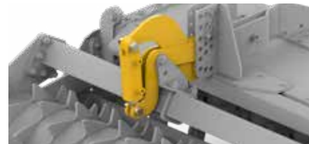
CONTRÔLE HYDRAULIQUE DE PROFONDEUR
