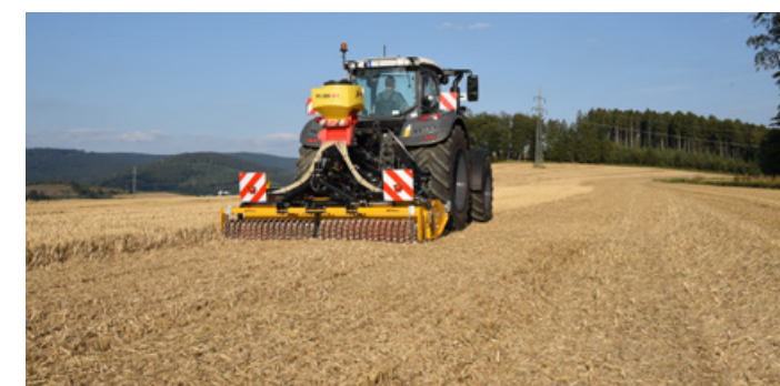
Le CoverSeeder laisse un résultat propre. Les restes de récolte sont traités et restent en surface.
