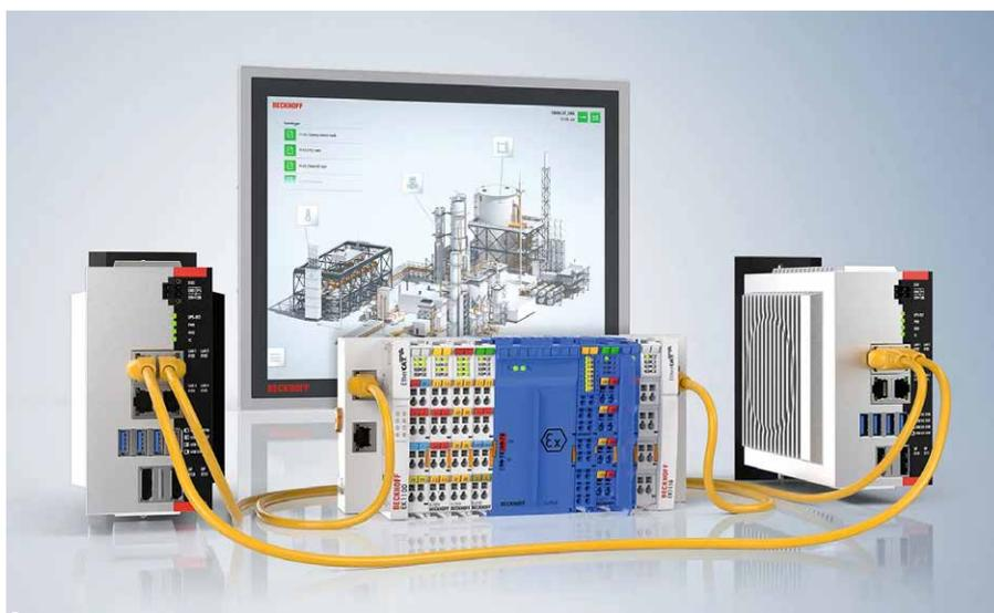
↳ Beckhoff Automation a lancé sur le marché en 1986 sa première solution de contrôle/commande basée sur PC. L'entreprise allemande propose aujourd'hui par exemple une solution logicielle qui permet à deux PC industriels, qui exécutent le même programme d'automate, de fonctionner comme des contrôleurs redondants.
