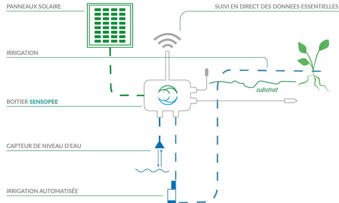
schéma : fonctionnement du système d'irrigation SENSOPEE
