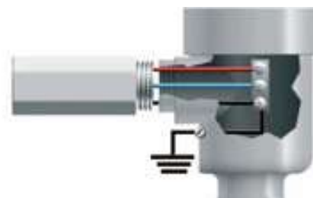
Bleu et marron: Circuit flottant Noir: Connexion à la terre
