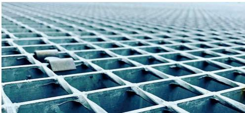
Le caillebotis électroforgé se compose de barres insérantes en carrés torsadés, électrosoudées dans les barreaux porteurs. La soudure à chaque point d'intersection entre les BP et les BI lui garantit une extrême solidité et robustesse.
