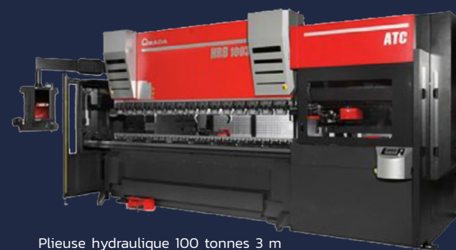
Plieuse hydraulique 100 tonnes 3 m avec magasin d'outils et contrôleur d'angle
