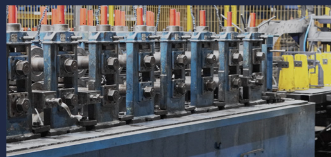
Ligne de profilage avec presse électrique et 13 opérations de profilage
