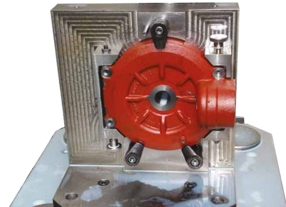
USINAGE D'ÉLÉMENT DE MACHINE AGRICOLE EN FONTE 600 X 600 MM
