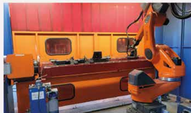
SOUDURE ROBOTISÉE CAPACITÉ 3000 X 1200 MM
