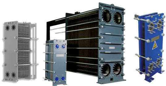
Les échangeurs à plaques et joints démontables sont composés d'un ensemble de plaques métalliques corrugées/cannelées par estampage à froid. La forme particulière de nos plaques leur confère un haut niveau de turbulence des fluides et un échange thermique optimal.
