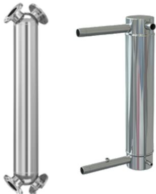
Notre échangeur tubulaire spiralé inox est un échangeur en calandre composé d'un faisceau de tubes spiralés en acier inoxydable. La conception spiralee permet une surface d'échange importante pour un échangeur en calandre et un très haut rendement lié à la turbulence. Particulièrement adapté aux hautes pressions nous proposons cet échangeur pour des applications vapeur mais de nombreuses applications industrielles ou CVC sont possibles.
