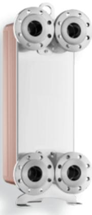
Les échangeurs à plaques brasées sont composés d'un ensemble de plaques en Acier Inoxydable AISI 316 corrugées/cannelées. La forme particulière de nos plaques leur confère un fort niveau de turbulence des fluides avec un échange thermique optimal et un encrassement réduit.
