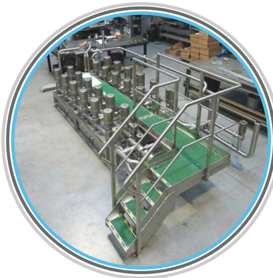
Tous nos manifolds sont réalisés avec une soudeuse orbitale, garantissant ainsi une haute qualité et régularité des soudures. Ce type de procédé permet également une parfaite traçabilité des soudures.
