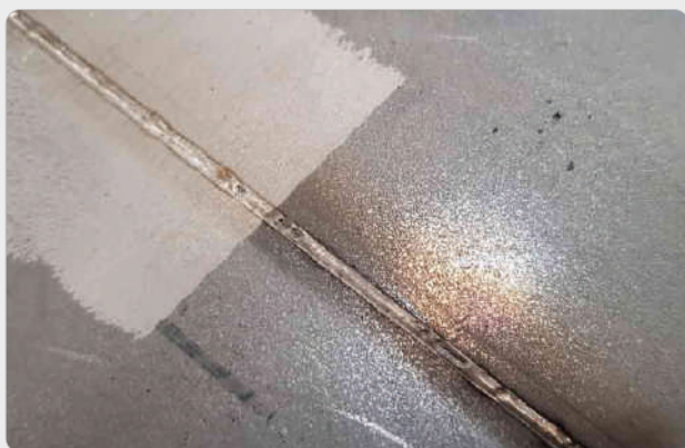
Nettoyage de l'oxydation avant et après le soudage
