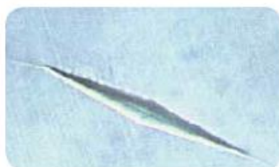
Micrographie Sphérotène® 160 \mu m « Knoop indentation sous 1 kg »
