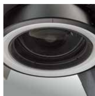
Utilise un objectif télécentrique
