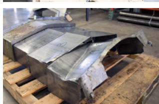
4. Si un outil ou une pièce d'usinage vous est tombé sur le protecteur, un nouvel élément de caisson peut s'avérer nécessaire.
