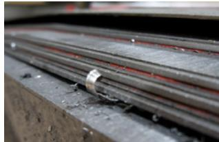
1. Des ouvertures se forment sur le protecteur, les copeaux s'accumulent sous la lèvre du racleur ou les racleurs deviennent poreux ? Alors il est grand temps de remplacer les racleurs. Vous devez inspecter les racleurs au moins une fois par semaine et les remplacer en cas de besoin.
