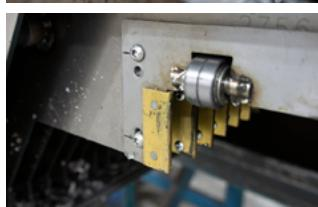
2. Est-ce que le protecteur grince lors de l'usinage de vos pièces ? Alors les éléments de glissement et de roulements à l'intérieur du protecteur doivent être inspectés.
