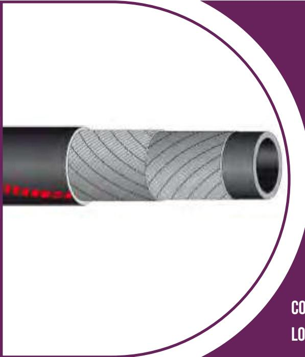
Ce tuyau nappé textile réalisé en caoutchouc antistatique et résistant à l'abrasion est préconisé pour **le dépotage de pulvérulents tels que le ciment, le sable, les graviers, la silice et autres abrasifs secs.**
