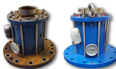
EXEMPLE DE RECONDITIONNEMENT D'UN BOÎTIER D'AGITATION
