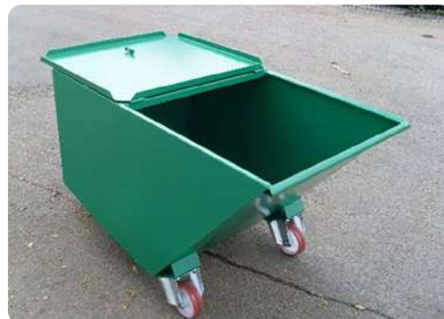
Couvercle rabattable avec partie fixe
