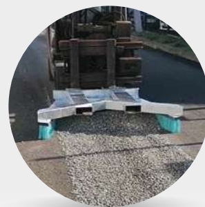
Balai en forme de « V » + double lame parallèle
