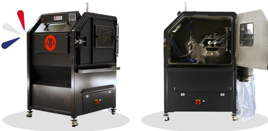
Conçues notamment pour les traitements post fabrication additive SLS MJF
