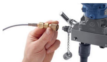
Un raccord rapide avec valve anti retour installé sur le manifold facilite le raccordement d'un calibre via un flexible
