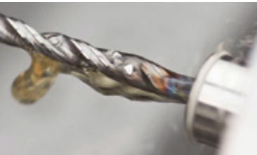
Les copeaux fragmentés s'évacuent le long des goujures de foret.
