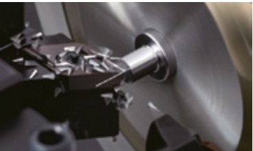
Micro-usinage d'une aiguille de diamètre 0.2mm
